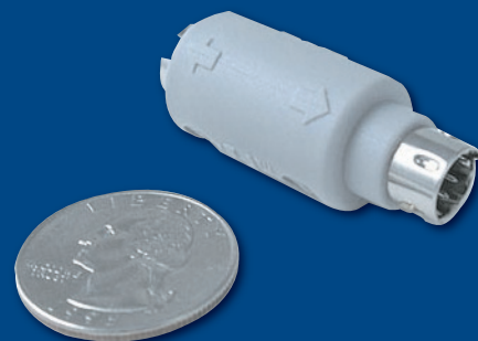
⚠ Ecco un keylogger "fisico" si inserisce fra il computer e la tastiera.
